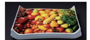
Les encres à base d'eau sont sujettes à des déformations telles que l'ondulation et le tuilage.
